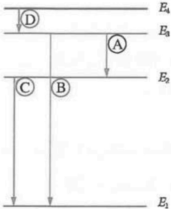
40- يمثل الشكل المجاور عدة انتقالات (A, B, C, D) بين مستويات الطاقة للكترون ذرة الهيدروجين، الانتقال الذي ينتج عنه انبعاث فوتون بأكبر طاقة:
