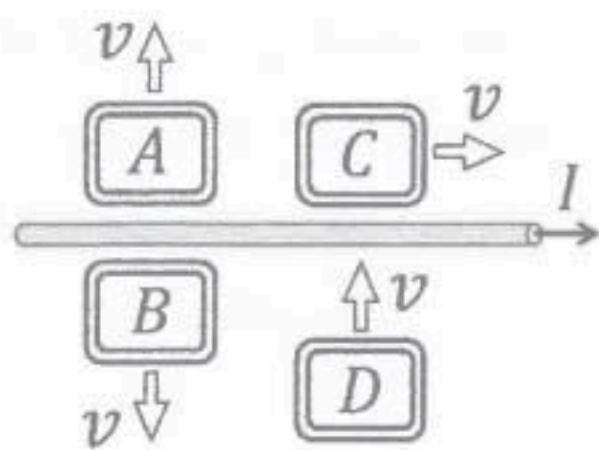
26- يبين الشكل المجاور أربع محاولات مختلفة لتوليد تيار كهربائي حتى في الملفات ( $A, B, C, D$ ) التي تتحرك في المجال المغناطيسي لموصل مستقيم يسري فيه تيار. الملفان اللذان يتولد فيهما التيار الكهربائي الحثي بالاتجاه نفسه هما:
