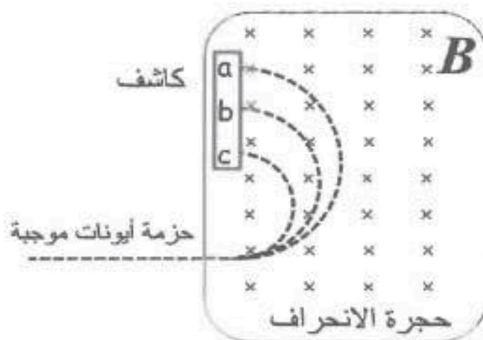
21- يبيّن الشكل المجاور تحليل عينة مجهرولة باستخدام جهاز مطياف الكثة. اعتماداً على الشكل فإن انحراف الأيونات ( $a, b, c$ ) يختلف بسبب اختلافها في:
